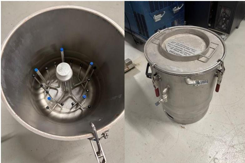
Flaschenmodul für Kegreiniger (Syphon und Bügel)
